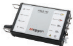
» Analizador de barrido de frecuencia industrial.
