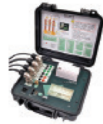
» Analizador de circuito de breakers.
